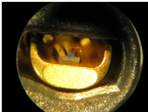
Abbildung 2.4: Laserdiode mit InGaAlP Kristall
