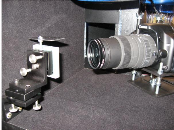
Abbildung 2.22: Gitterhalterung mit Einstellschrauben[8]
