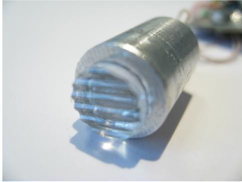
Abbildung 2.6: Laserkopf mit Linienmodul
