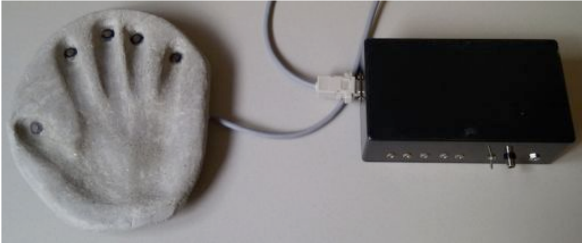
Abbildung 10: In dieser Abbildung ist die benutzte Ansteuerung und die Handhalterung mit eingebauten Stimulatoren ersichtlich. Die Ansteuerung wurde auf einer Seite mit den digitalen Ports, auf der anderen Seite mit den Stimulatoren der Handhalterung, verbunden.
