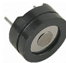
Abbildung 9: Foto des verwendeten Audio Transducers KSQG706BP von Kingstate
