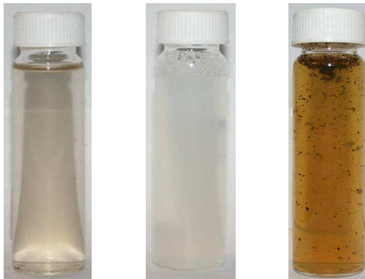
Abbildung 7.17: Kondensat (links), Destillat (mitte), Konzentrat (rechts); Versuch Kont03
