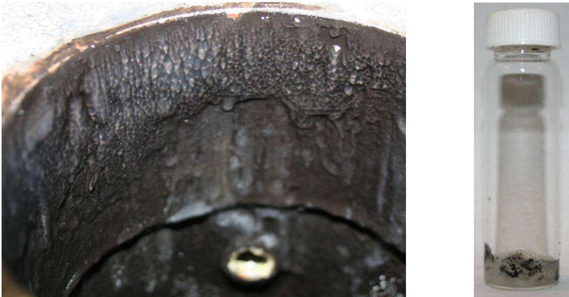
**Abbildung 7.24: kondensierte Ablagerungen**
