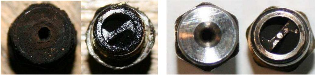
**Abbildung 7.23: Düse vor der Reinigung (links) und nach der Reinigung (rechts)**
