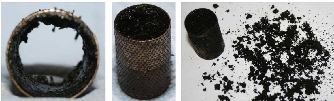
**Abbildung 7.15: Filtersieb (links und mitte), gelöste Ablagerungen (rechts)**
