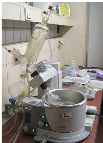
Abbildung 7.1: Rotationsverdampfer
