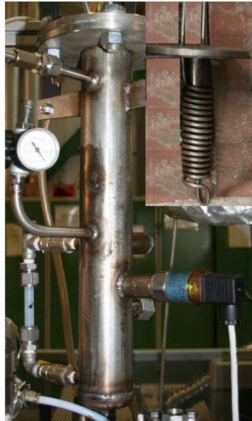
Abbildung 6.13: Kondensator
