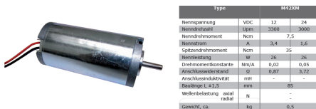
Abbildung 74: Details des DC Motors 50
