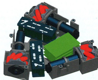
Die Fortbewegung auf 3 Achsen = 360 Grad Bewegungsfreiheit: Omnidirve
