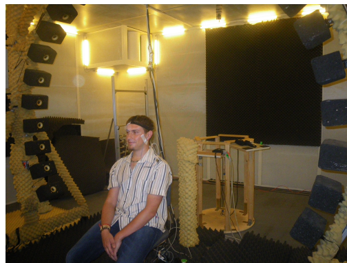
Abbildung 4.1: HRTF-Messung in dem semianechoischen Raum der ÖAW
