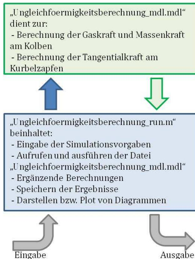
Abbildung 82: Prinzip des Berechnungsablaufs in Matlab
