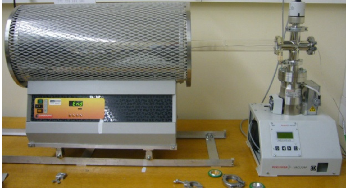
Abb. 3.1: Der Rohrfen ist auf Rollen und Schienen montiert, um ihn einfach über das evakuierte Glasrohr zu schieben, worin sich die Probe befindet.
