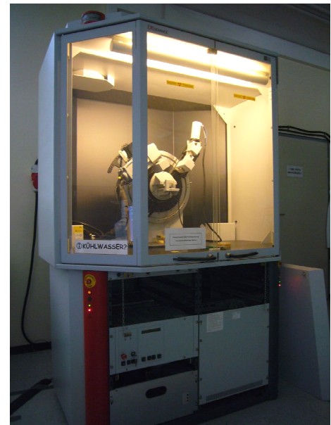
Abb. 3.3: Der Strahlengang des Diffraktometers und ein Bild vom D8 Advance der Fa. Bruker im Vollschutzgehäuse ( www.bruker-axs.de ).
