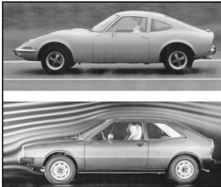
**Abbildung 2.5: Darstellung des Opel GT (stromlinienoptimiert) und VW Scirocco (detailoptimiert), [1]**
