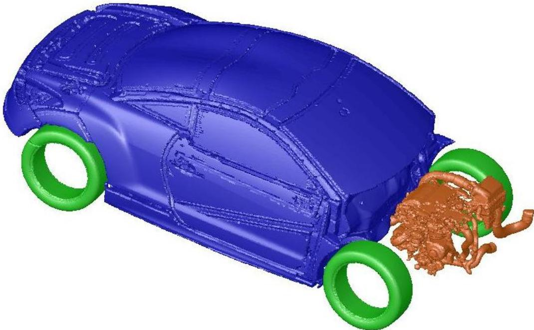
**Abbildung 5.12: Patches für Innenraum, Reifen und Abgassystem mit Motor**
