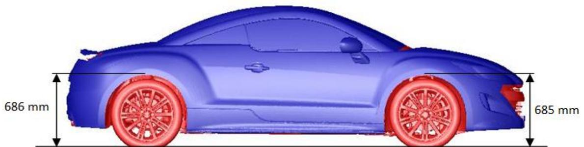
**Abbildung 5.27: Höhenstand an Vorder- und Hinterachse**
