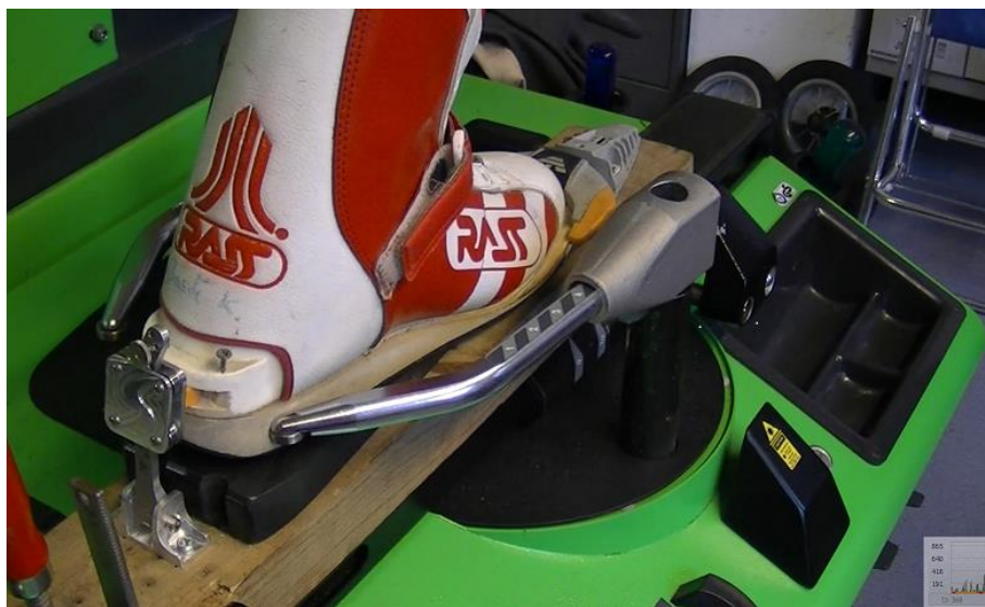
Abbildung 21: Auslösetest mit WINAIR-Vorderbacken und Typ-3 Hinterbacken
