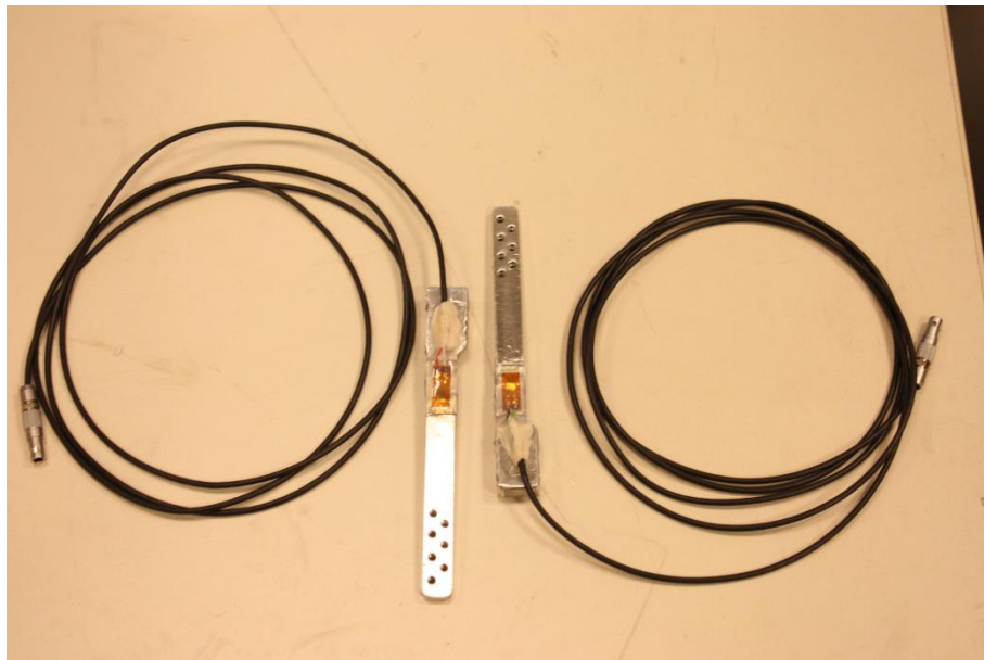
Abbildung 66: Koppelstäbe mit Typ-6/120 LY63 DMS und versorgter Applikationsstelle
