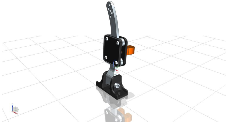
Abbildung 27: Typ-3 Hinterbacken mit Flachstab
