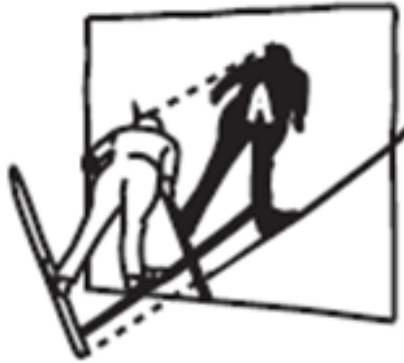
Abbildung 65: Wirksame Stirnfläche (Schattenfläche) in Anströmrichtung
