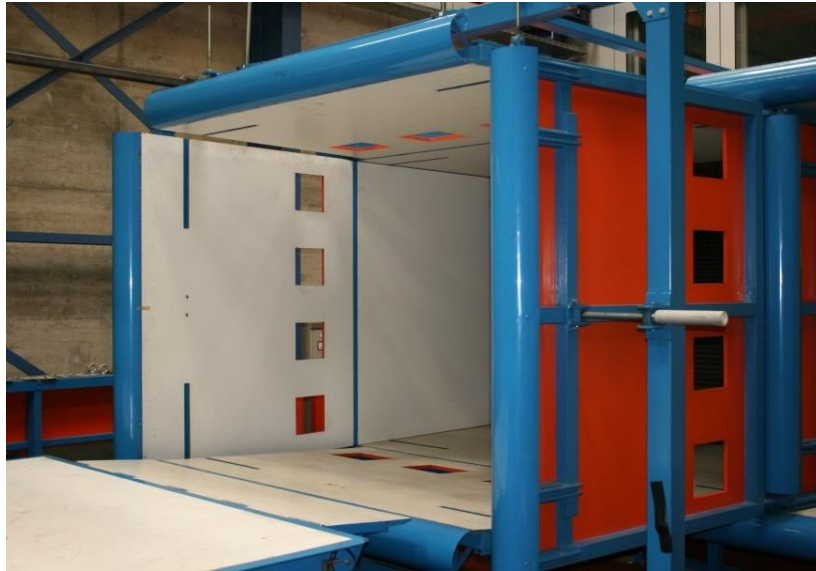
Bild 2.4: Kollektor des 2m-Windkanales am ISW; gut zu erkennen sind die Öffnungen, aus denen überschüssige Luft entweichen kann, sowie der halbkreisförmige Kollektormund
