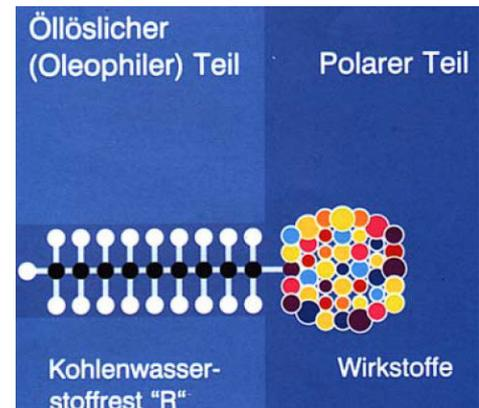
**Abb. 3.10** Aufbau eines Additivs [17]
