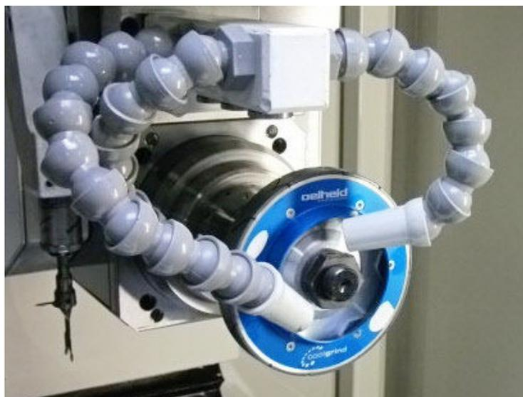
**Abb. 2.6** Richtige Zustellung der Kühl-/Schmiermittelschläuche
