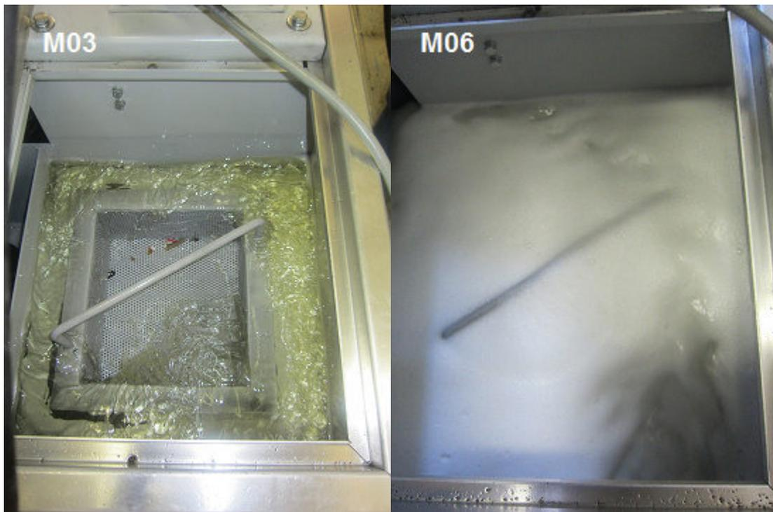
**Abb. 3.14** Vergleich der Schaumbildung (M03 zu M06) innerhalb der Filteranlage
