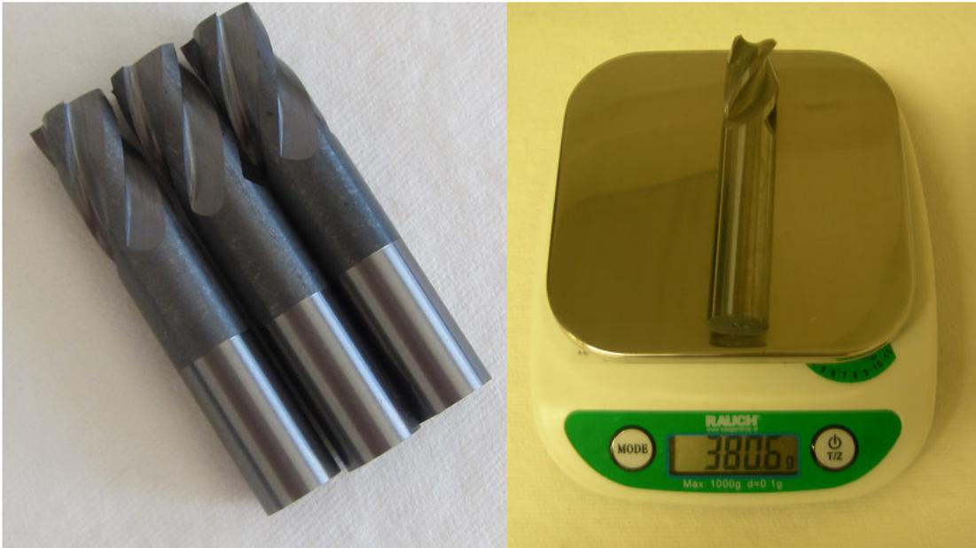
**Abb. 5.3** Geschliffene Prüflinge mit darauffolgendem Gewichtsvergleich mittels Feinwaage der Firma Rauch
