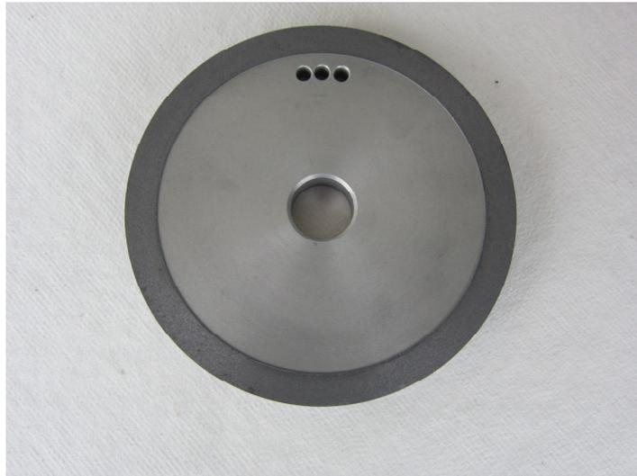
**Abb. 2.17** Tesch Diamantschleifscheibe
