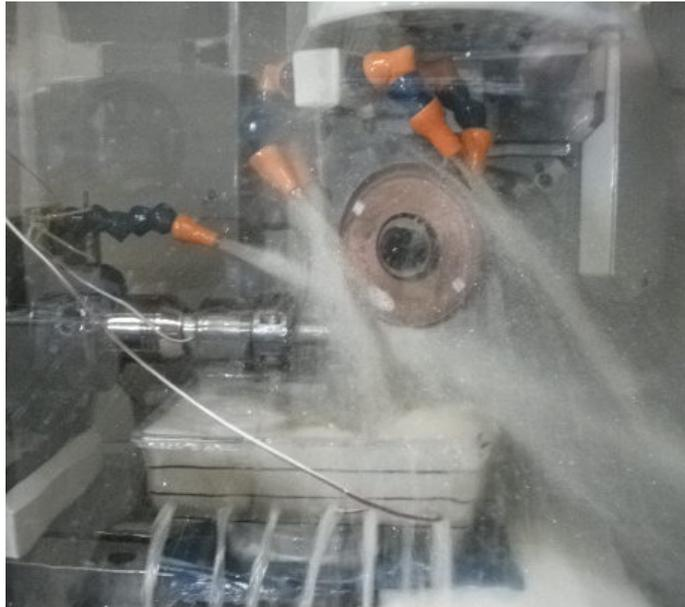
**Abb. 3.5** Kühlschmierstoffeinbringung bei der Bearbeitung
