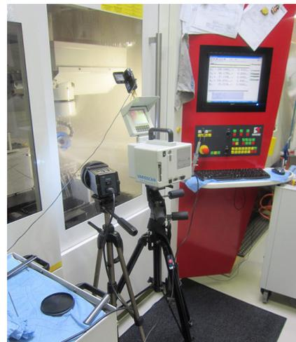
**Abb. 4.1** Saacke CNC - Schleifmaschine mit Stroboskoplampe, Videokamera und Thermokamera
