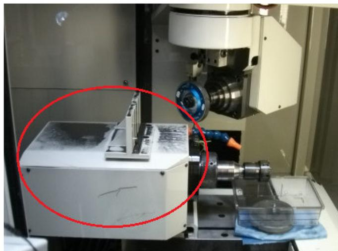
**Abb. 4.20** Verschmutzung im Bearbeitungsraum mit Coolgrind Scheibe
