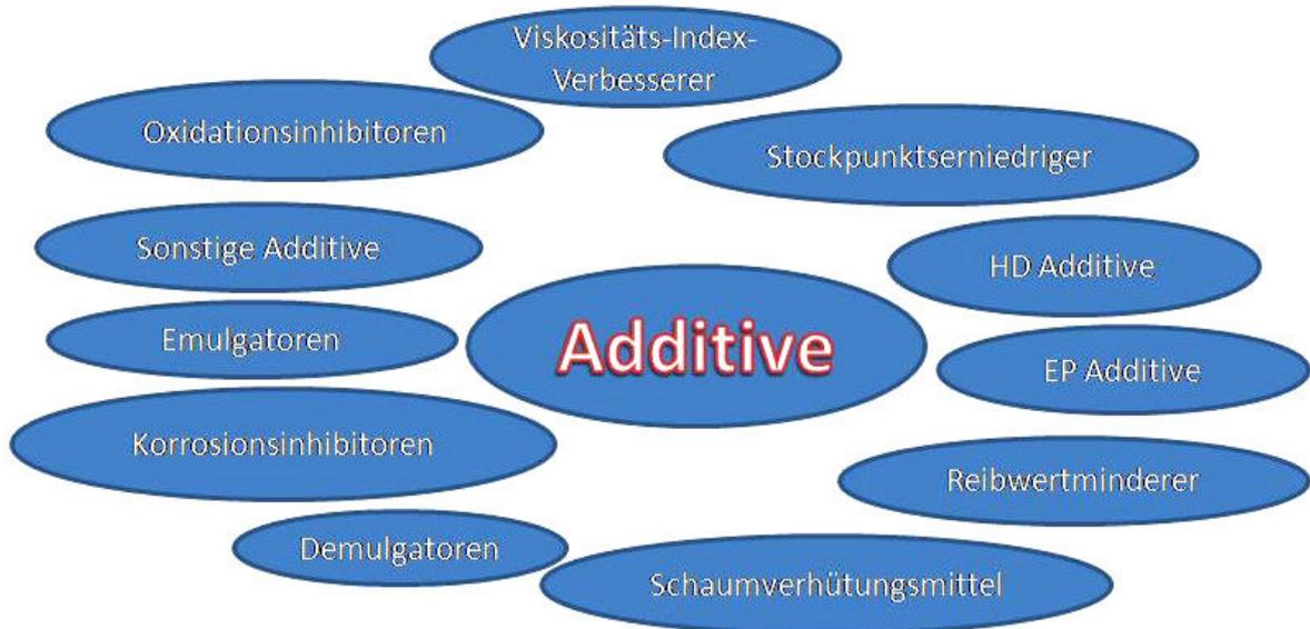
**Abb. 3.9** einsetzbare Additive zur Basisflüssigkeit
