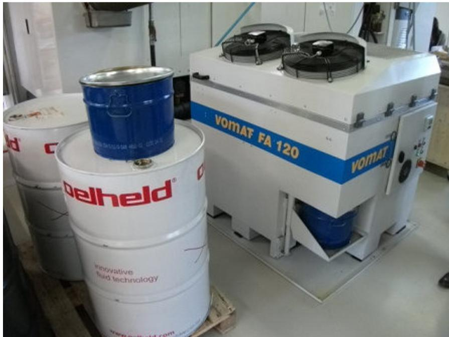
**Abb. 3.1** Gelieferte Kühlschmierstofffässer, im Hintergrund die Filteranlage
