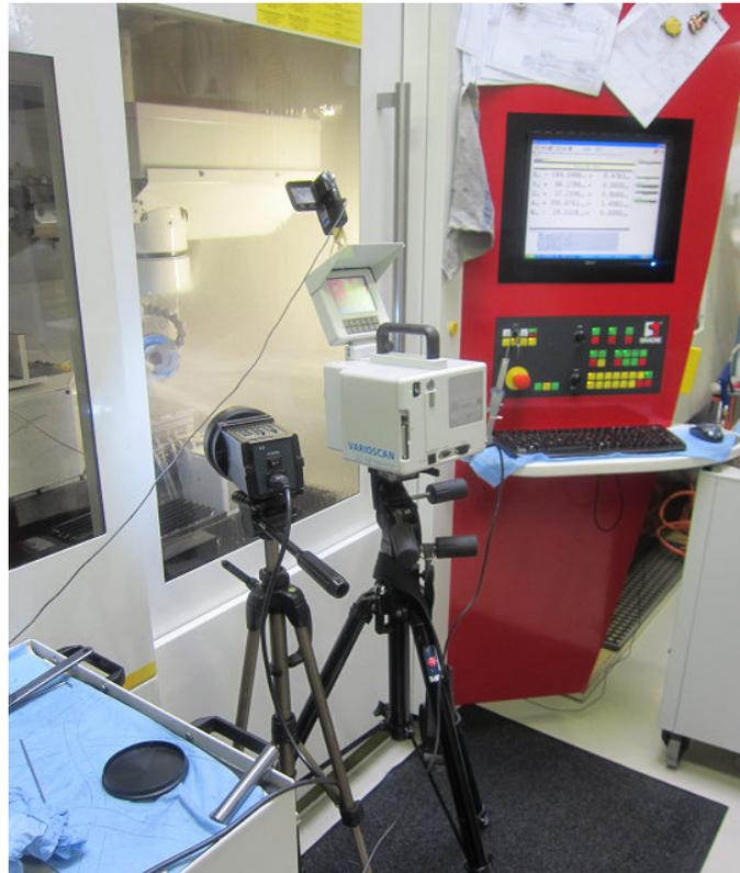
**Abb. 4.17** Aufbau von Thermokamera und Stroboskop
