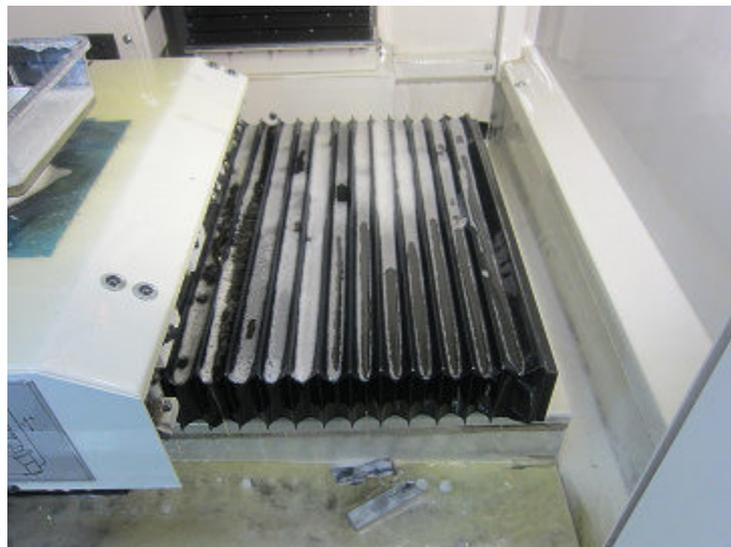
**Abb. 3.13** starke Schaumbildung am Faltenbalg von Medium M06
