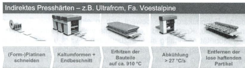
Abbildung 2.7: Prozessablauf beim indirekten Presshärten, P. Dick [2008]
