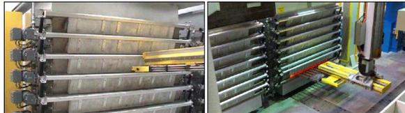
**Abbildung 2.39:** Mehrlagenmehrkammer (MLK) Ofen der Schwartz GmbH, Lehmann [2011]
