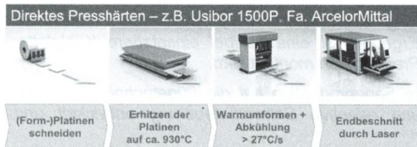
**Abbildung 2.5:** Prozessablauf beim direkten Presshärten, P. Dick [2008]
