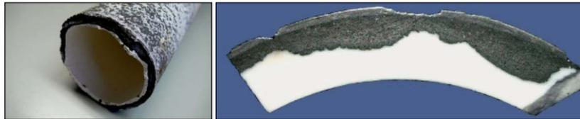
**Abbildung 2.24:** Thermochemischer Angriff auf Rollen (bei AlSi-beschichtetem Material), Pfeifer et al. [2011]
