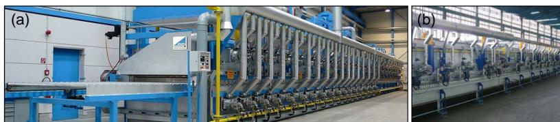
**Abbildung 2.21:** Rollenherdöfen für das direkte Presshärten, (a) Schwartz GmbH und (b) LOI Thermoprozess GmbH
