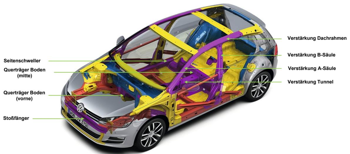
**Abbildung 6.1:** Pressgehärtete Bauteile im neuen VW Golf VII, Stahl-Informations-Zentrum / Volkswagen AG [2012]
