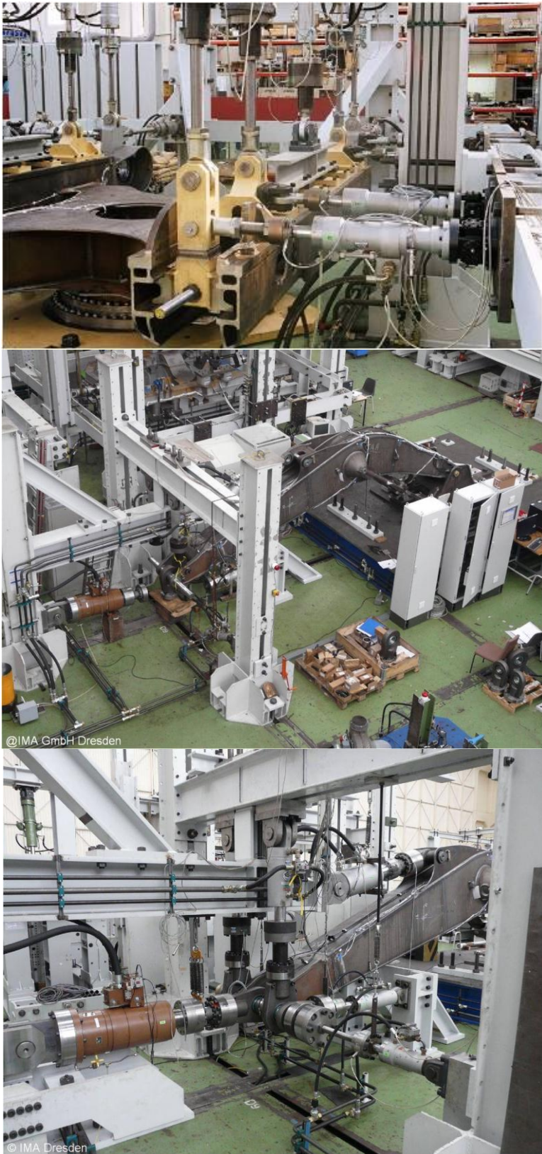
Abbildung 2-11: Beispiele von Schwingprüfständen, oben: Prüfung eines Raupenbagger-Unterschwagens; Mitte und unten: Prüfung eines Bagger-Monoblockauslegers
