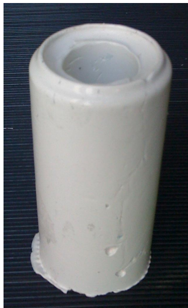
Abbildung 4: Gussform aus Silikon (Silcolan HV)
