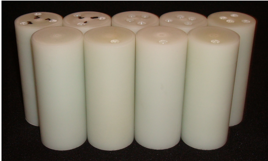
(a) Phantome für die optische Tomographie
