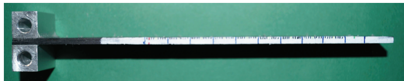
Abbildung 3.14.: Mode I Prüfling mit Aluminiumblöcken, weißer Seitenfläche und Millimeter-Skala
