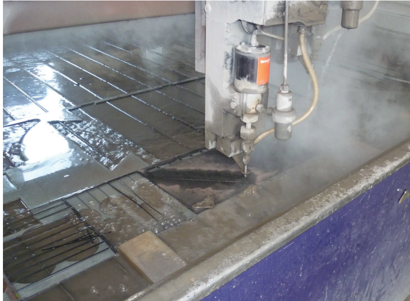
Abbildung 3.10.: Abrasives Wasserstrahlschneiden der Prüflinge
