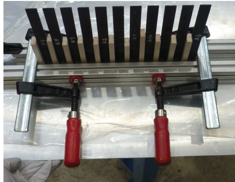
Abbildung 3.13.: Fixierung der Aluminiumblöcke bei der Klebung durch Schraubzwingen
