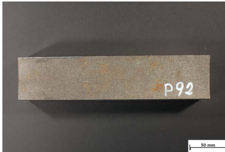
Abbildung 18 Segment der Dampfrohrleitung des P92 für die Probenerzeugung
