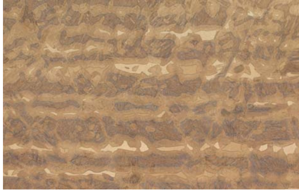
(a) Gefüge nach Glühen bei 1300°C
