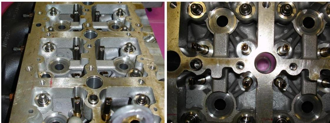
Abbildung 7-10: Dummy-Zylinderkopf mit Ventilstößelkonstruktion
