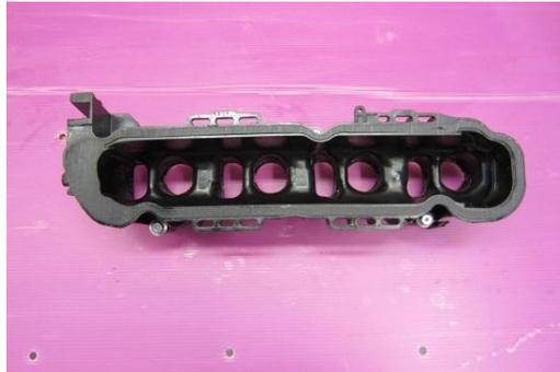
Abbildung 7-2: Dummy-Sauganlage
