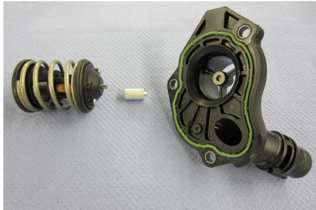
Abbildung 5-4: Aufgespreizter Thermostat
