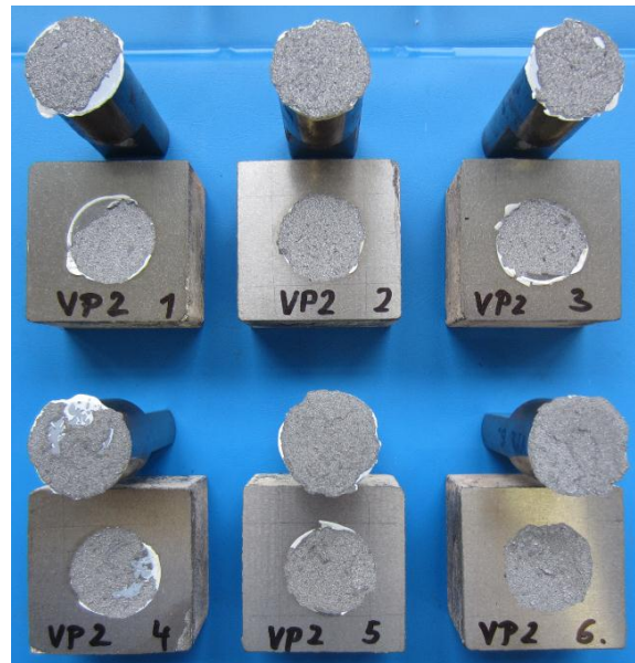
Abbildung 89: Ergebnisse Haftzugversuche und Bruchaussehen A1
