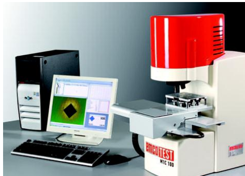
Abbildung 35: Härtemessgerät M1C 010 der Fa. Emco [53]
