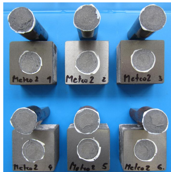
Abbildung 88: Ergebnisse Haftzugversuche und Bruchaussehen / Metcoloy 2
