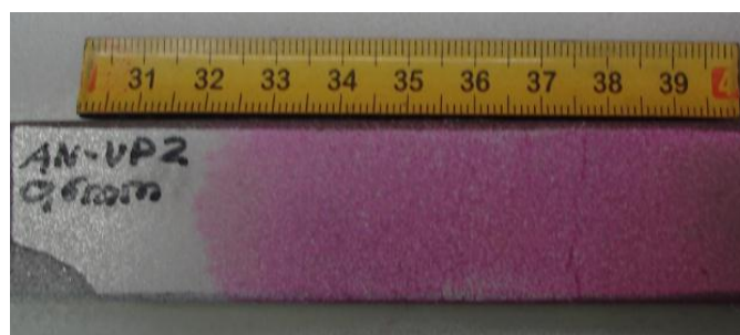
Abbildung 86: PT-Prüfung vom A1, Riss bei s=0,6mm
