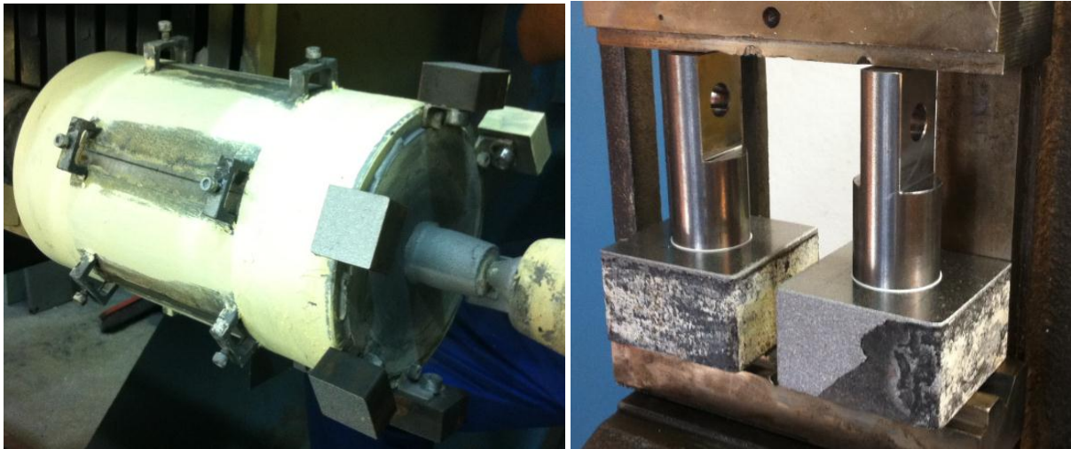
Abbildung 41: Probenherstellung für den Haftzugversuch
