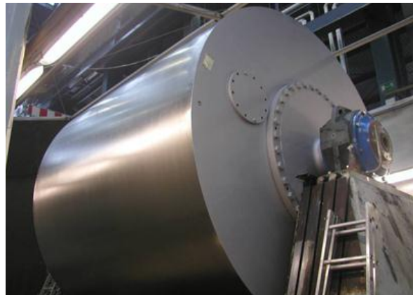
Abbildung 1: Fertig beschichteter und polierter Stahlyankee [2]
