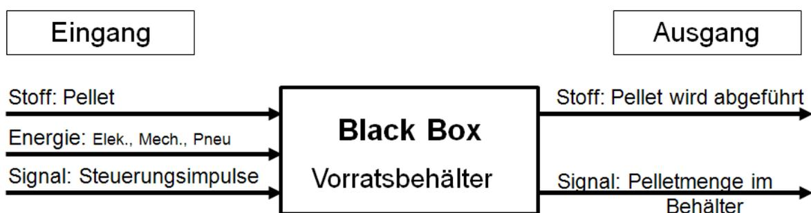
Abbildung 4-5: Die Darstellung der Black-Box des Vorratsbehälters
