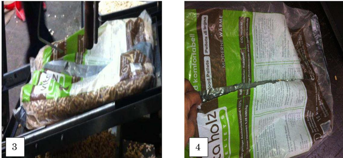
Abbildung 4-12: Versuch Nr. 1, der Pelletsack wird mittig geschnitten.
