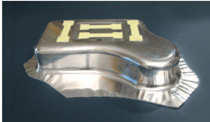
Abbildung 6: Pressteil aus MgF DDQ(Deep-Draw Quality) [7]
