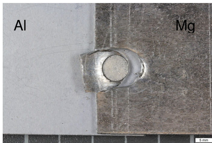
Abbildung 74: Probe N.Z.6 Bruchfläche Halbhohlstanznieten ohne Klebstoff
