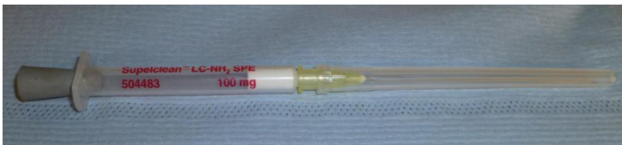
Abb. 3.2: SPA-Sample: verschlossene Entnahmespritze mit darin befindlichem Absorber
