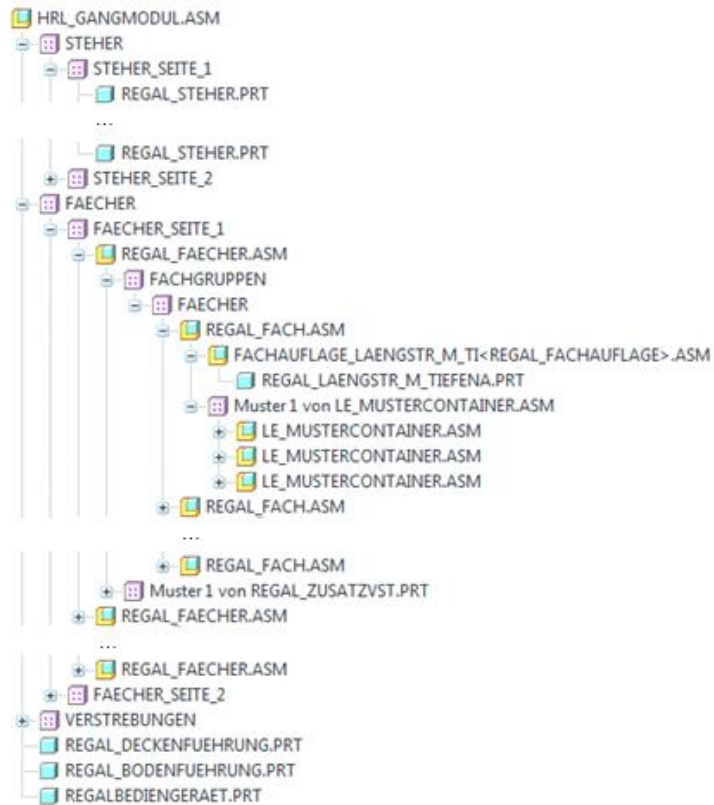
Abbildung 4-8 Pro/Engineer Modellaufbau eines Gangmoduls
