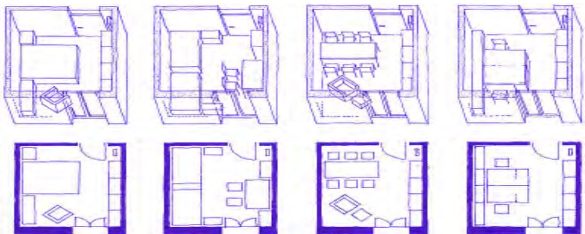
Abbildung 14: Flexibles Nutzungskonzept (Quelle: Preisig, H.R.; Dubach W.; Kasser, U.; Viriden K.: Von der Ökologischen Konstruktionspraxis - A-Z Handbuch für Kostenbewusste Clients, Winterthur)
