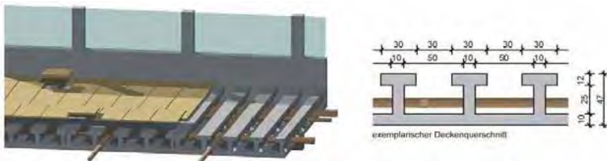
Abbildung 27: Stegdecke mit integrierter Haustechnik (Quelle: RWTH Aachen)
