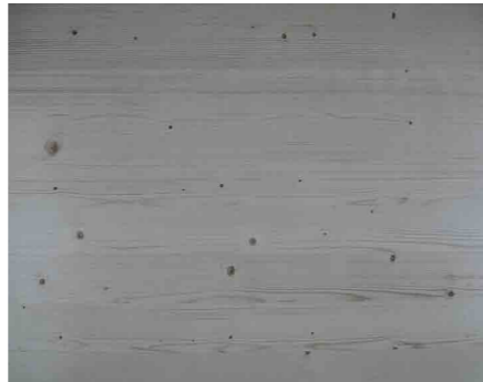
Abb 2. Holztäfer - Nut und Kamm, 2.0cm, Weisstanne, glatt geschliffen als Wandverkleidung und feiner Bandsägeschnitt als Innenwandoberfläche (1.5% Weißpigment verringert Nachdunkelung)
