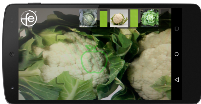
Abbildung 6.3.: Als Ergebnis eines Lebensmittel-Scans werden am oberen Bildschirmrand die besten drei Ergebnisse der Bilderkennung zusammen mit kleinen Balken, die die Passgenauigkeit im eigenen FE-Typ (hier Brain Food) angeben, eingeblendet.
