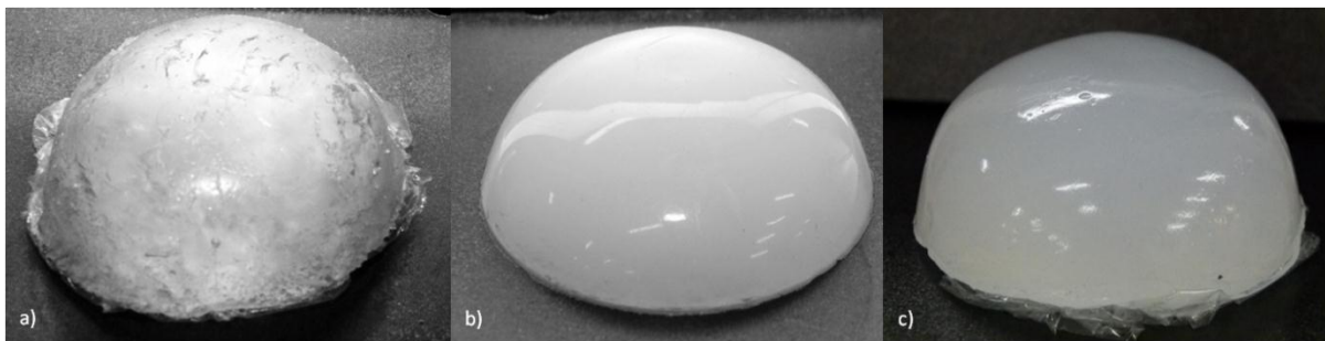
Abbildung 3.6: Proben zum Materialvergleich aus a) Silikongel b) Silikon c) Agar
