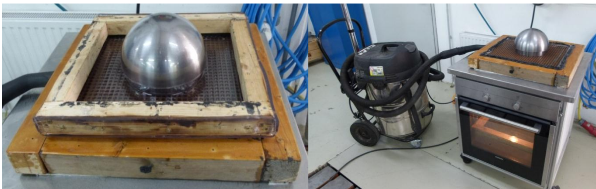
Abbildung 3.8: Tiefziehen: Grundrahmen, Aufspannrahmen und Positivform
