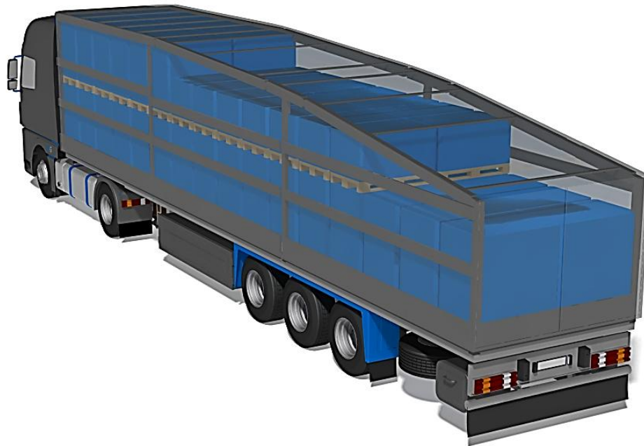
Abbildung 8.7: Fernverkehrsattelzug 40to Klasse beladen – Heck eingezogen
