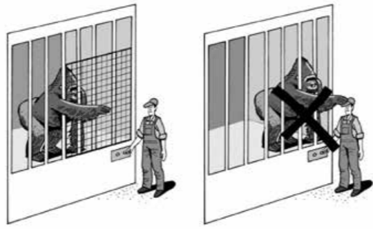
Abb. 112 Sicherer Standort bei der Schieberbetätigung.
