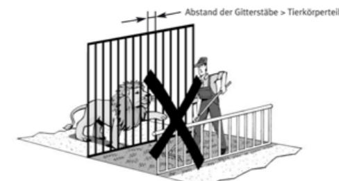
Abb. 131 Unzulässige Arbeitsweise bei Arbeiten hinter der Umwehrung.
