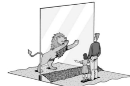
Abb. 132 Glaswand als Einfriedung (keine Umwehrung erforderlich).
