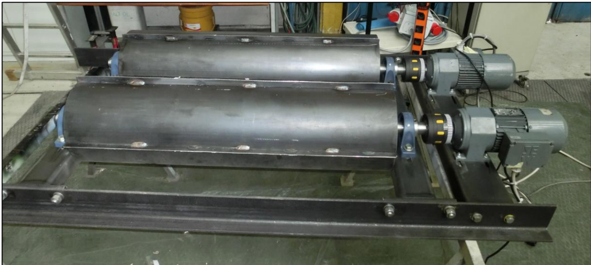
Abbildung 6-8 Walzen mit Stegblechen (hier bereits mit einer Höhe von 20 mm)
