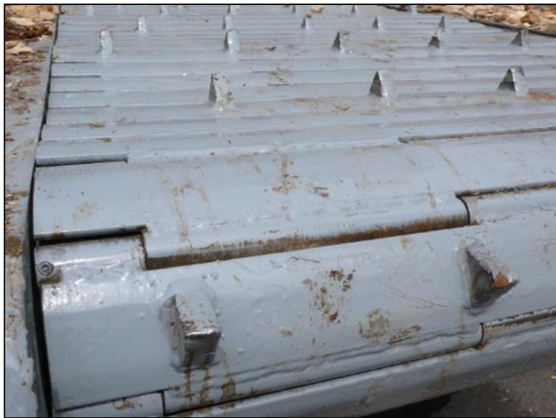
Abbildung 5-5 Profiliertes Einzugsgurt der Hackguterzeugungsmaschine Lindner ANTAGUAR P600
