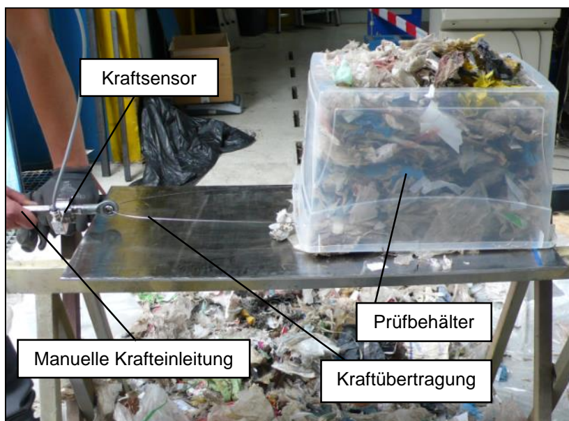
Abbildung 4-12 Prüfaufbau zur Reibkraftmessung
