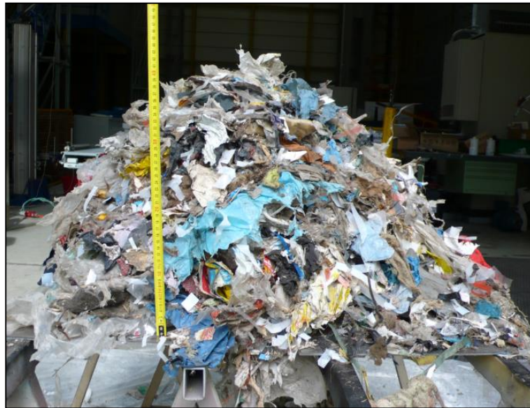
Abbildung 4-27 Aufgeschüttetes Schneidgut vor Versuchsdurchführung
