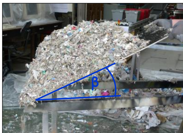
Abbildung 4-10 Versuchsaufbau mit eingezeichnetem Reibwinkel
