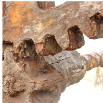
Der Salzgehalt der Luft ist, insbesondere in direkter Küstennähe extrem hoch. Jegliches, ungeschütztes bzw. unveredeltes Metall korodiert unverzüglich. Selbst Edelstahl setzt in Kürze Flugrost an.
