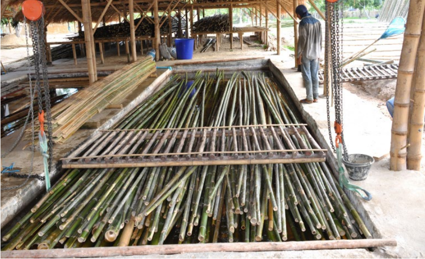
Abb. 51: Bambusstäbe werden in einem Konservierungsbecken gebadet.
