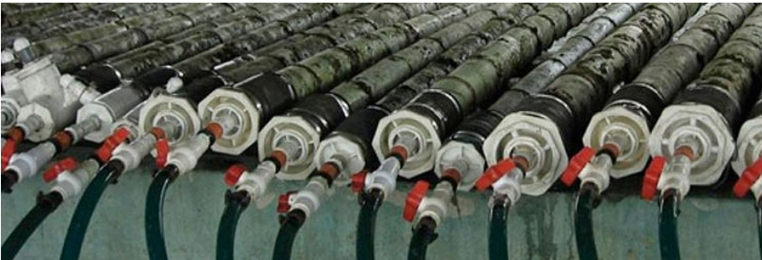
Abb. 52: Die kostenintensivere Schnellkonservierung der Stäbe. Per Druckluft wird das Konservierungsmittel durchgeblasen
