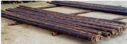
Abbildung 49 oben : Die Halme werden aufgelegt und vorsortiert auf Risse bzw. Schäden an den Halmen.
