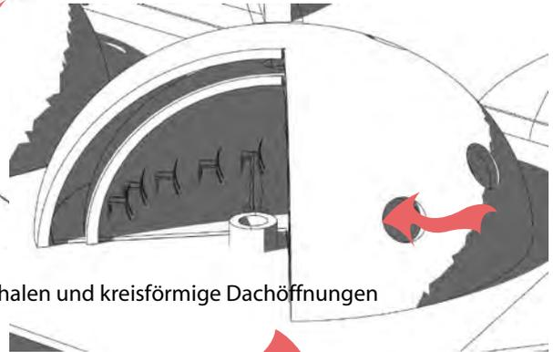
Belüftung durch kreisförmige doppelte Dachschalen und kreisförmige Dachöffnungen
