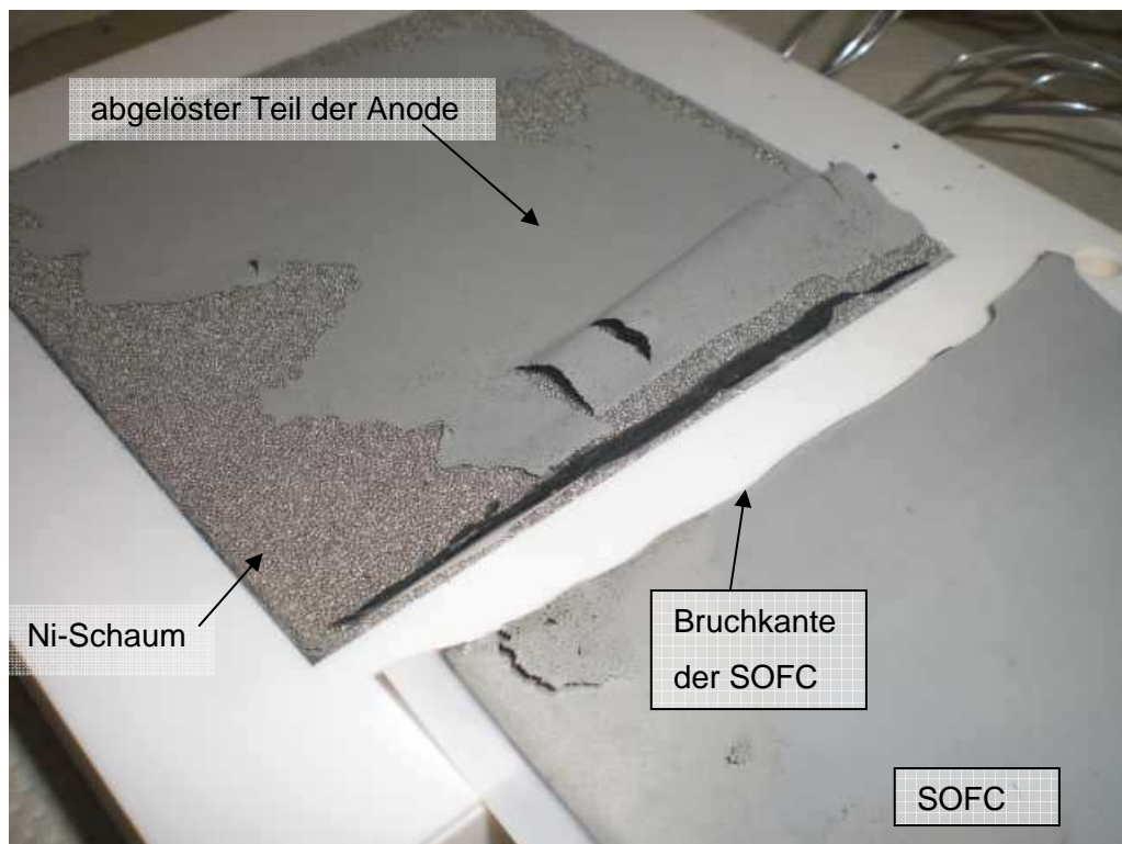
Abbildung 5-20: SOFC nach dem Versuch
