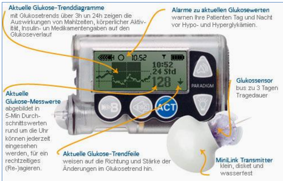
Abbildung 5: Paradigm® REAL-Time-System (Vorgänger des Revel-Systems); Medtronic[20]
