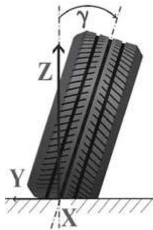
Abbildung 2.5.: Definition des Radsturzwinkels, Bildquelle [5]
