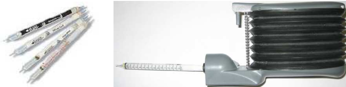
Abbildung 5-11: Dräger Probenahmeröhrchen und die dazugehörige Pumpe [24]
