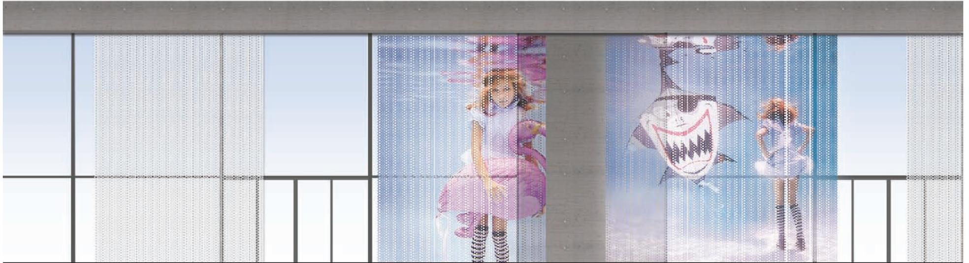
Fassadensystem - Sichtbeton/Glas mit vorgesetztem, gelochtem Trapezblech (Projektionsfläche)
