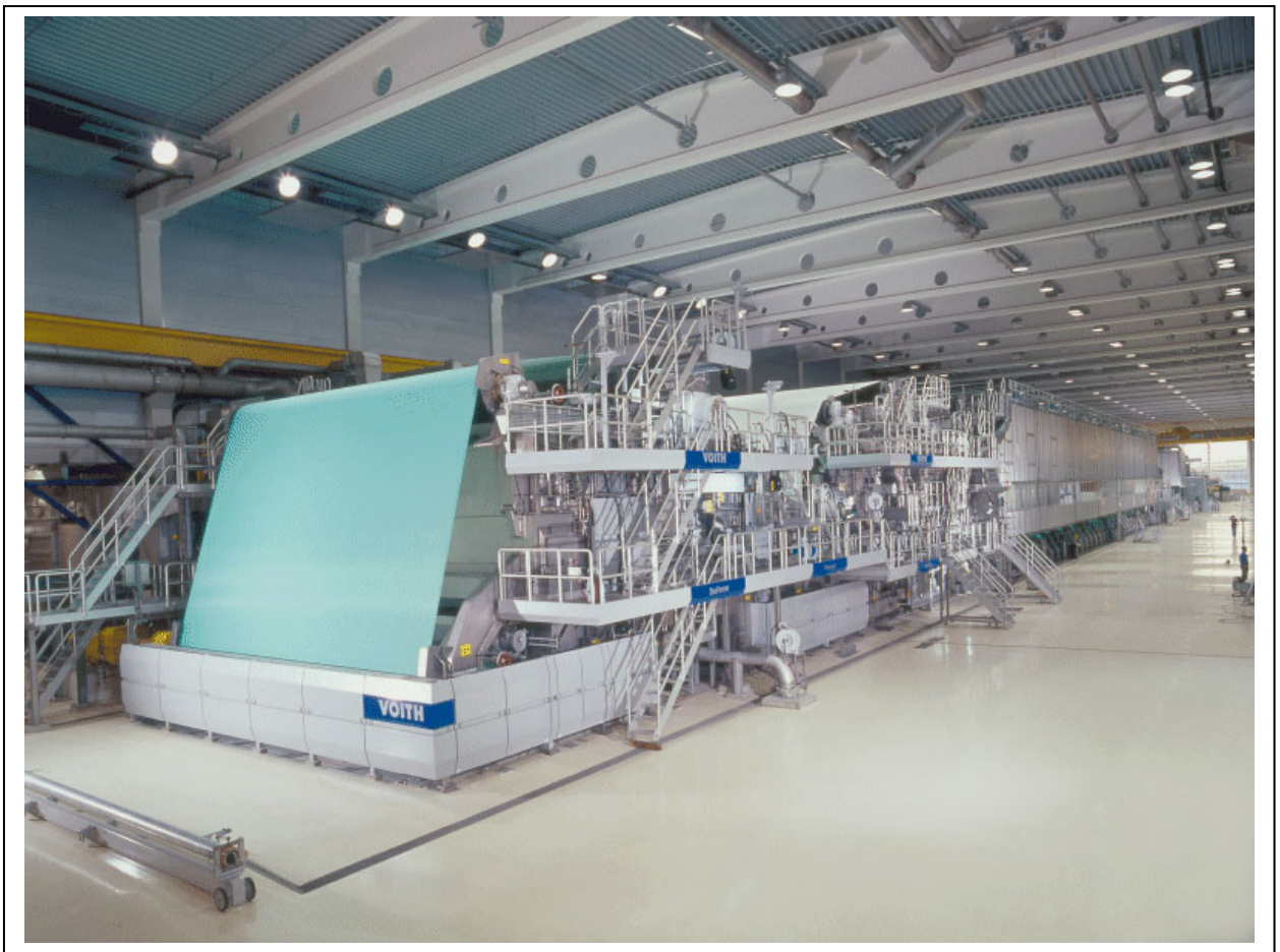
Abbildung 4-4: Komplett von Voith gelieferte PM4 der Leipa Georg Leinfelder GmbH in Schwedt an der Oder in Deutschland. (Blick auf die Siebpartie) 76
