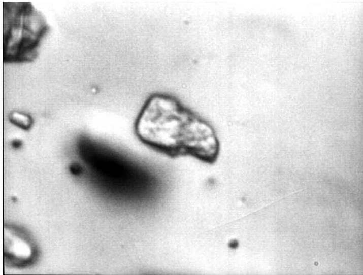
**Abb 6** Quarzkristall bei -70 Grad Celsius
