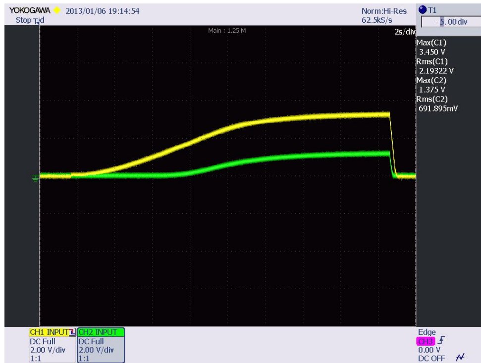
Abbildung 34: Test Mikrocontrollerschutz (gelb: gemessener Effektivwert, grün: Diodenspannung)
