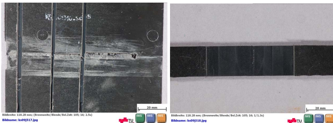
Abbildung 150: Entnahme der Biegeprobe aus der verschweißten Platte (links) abgefräste Probe (rechts)
