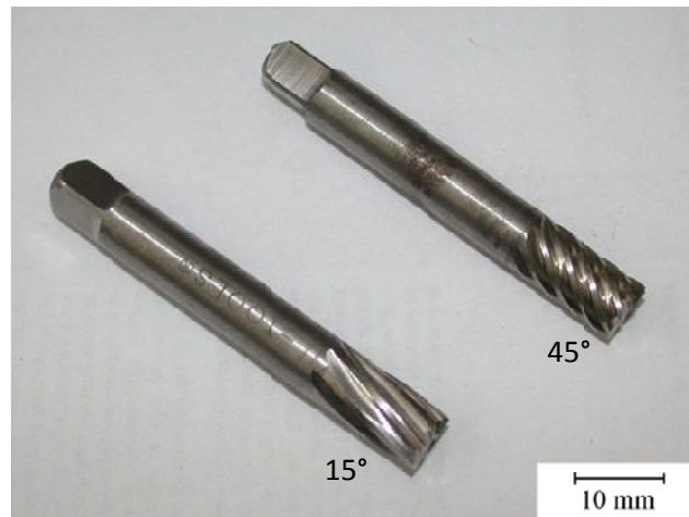
Abbildung 19: Fräswerkzeuge, 8-gängig mit einem Steigungswinkel der Schneide von 15° (links) und 45° (rechts)[23]
