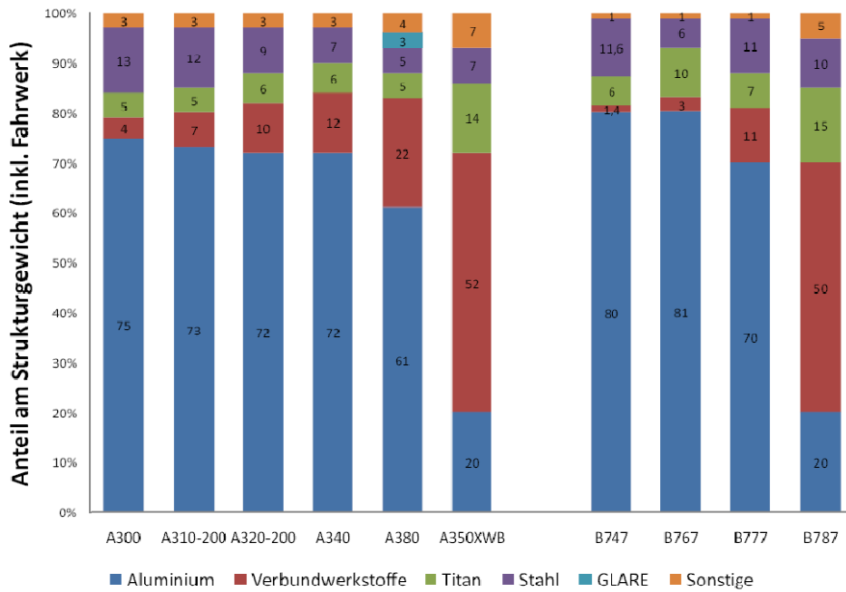
Abbildung 38: Relativer Werkstoffeinsatz in der Luftfahrt/ Airbus und Boeing (GLARE: glasfaserverstärktes Aluminium)[30]
