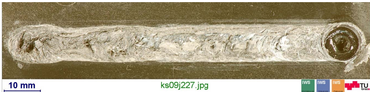
Abbildung 115: Schweißnahtaussehen der besten Schweißung KS_0905_S002 (Ultradur)
