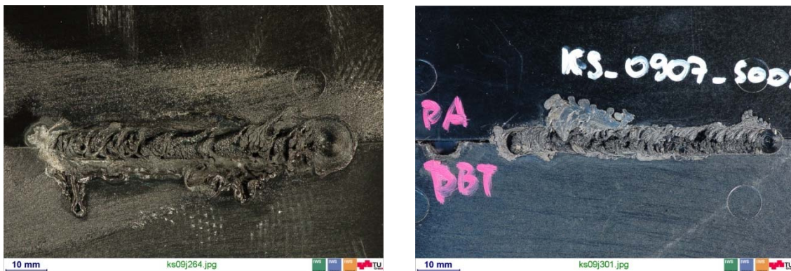
Abbildung 140: Verschweißen Ultramid und Ultradur: Werkzeug 2 (links) und stehende Schulter mit Stahlstift (rechts)
