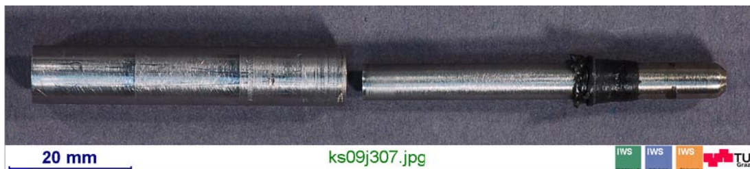
Abbildung 141: Werkzeug für Versuchsreihe KS_0907 (nach Pinbruch)
