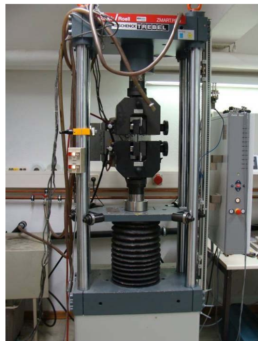
Abbildung 65: Zugprüfmaschine RMC100 mit mechanischen (links) und hydraulischen Klemmbacken (rechts)
