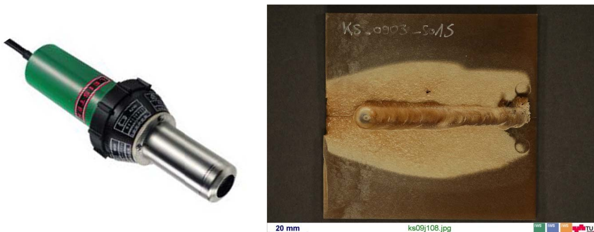
Abbildung 85: Wärmeeinbringung mittels Heißluftfön / Thermische Schädigung des Werkstoffs
