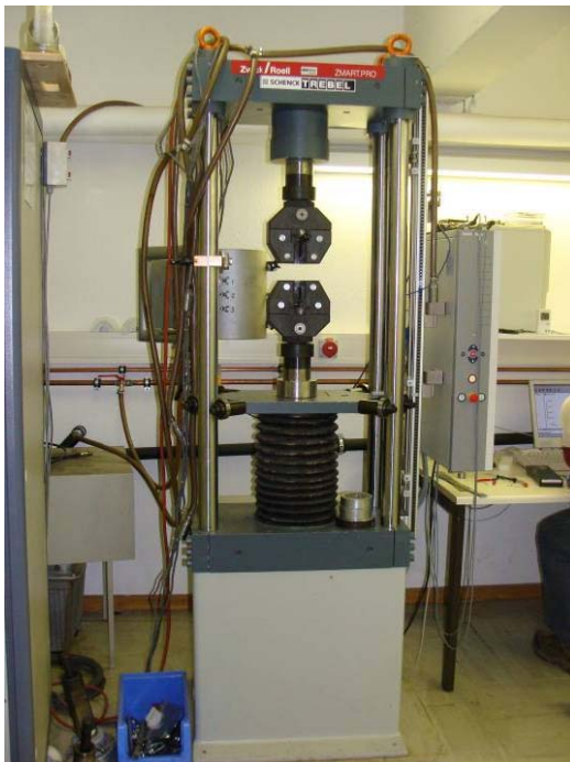
Abbildung 65: Zugprüfmaschine RMC100 mit mechanischen (links) und hydraulischen Klemmbacken (rechts)
