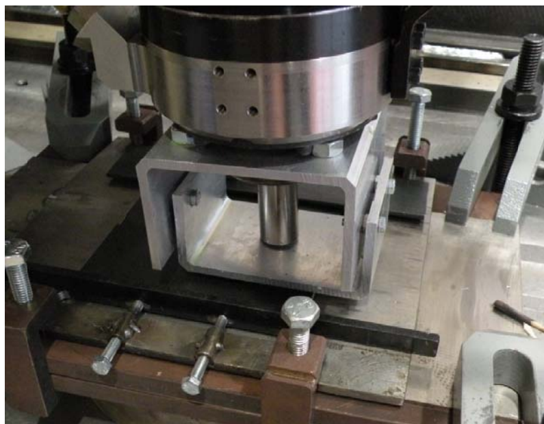
Abbildung 114: Stehende Schulter aus Aluminium und Werkzeug 3
