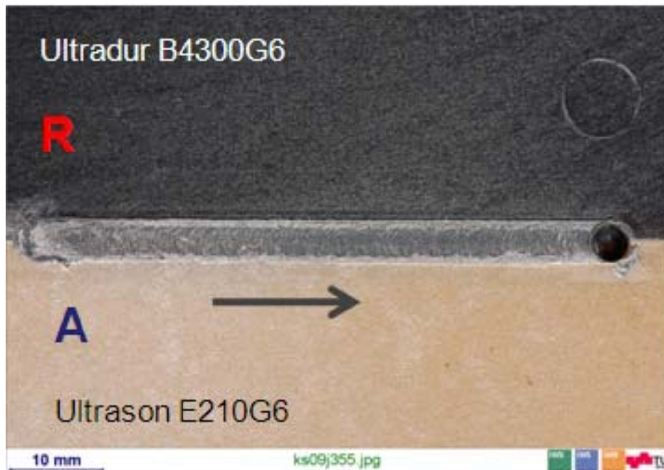
Abbildung 146: Dissimilar Welding von Ultradur und Ultrason-Schweißnaht
