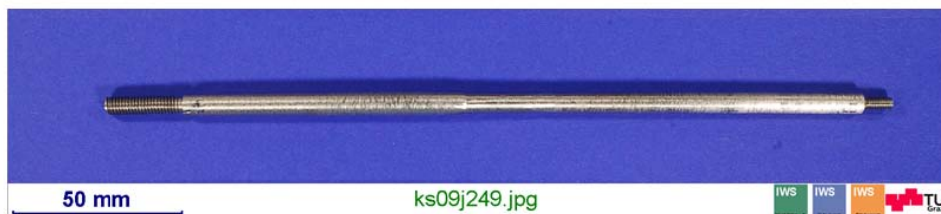
Abbildung 79: Adjustable Pin für Prototyp Heizplatte oben, Pinspitze mit Gewinde (rechts) (M4)
