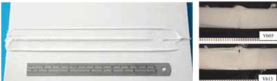
Abbildung 30: Optimiertes Nahtaussehen und Querschliffe typischer Viblade™-Schweißungen[21]
