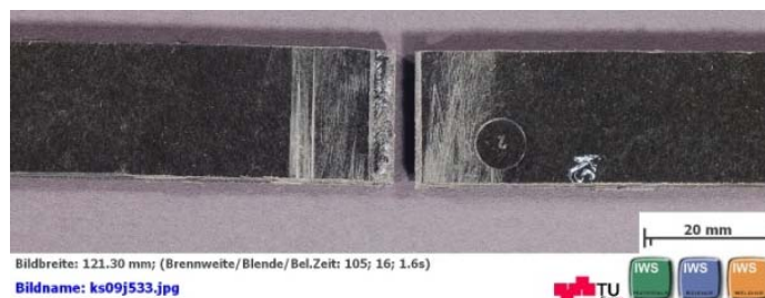
Abbildung 152: Biegeversuch Ultramid: gebrochene Probe verschweißter Querschnitt
