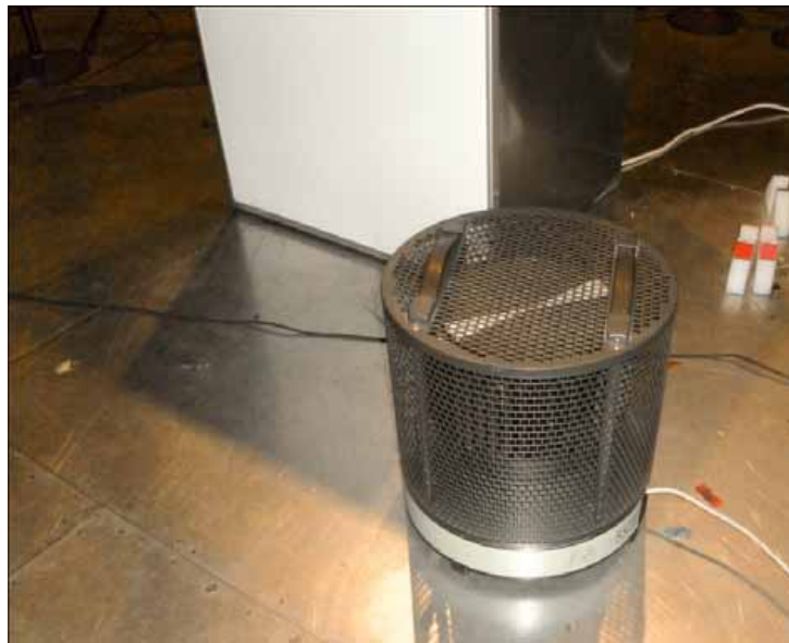
Abb. 2.3: Größe der Vergleichsschallquelle in Relation zum Kühlschrank
