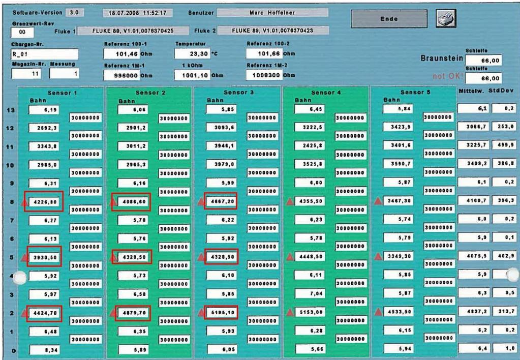
Abbildung 9-3; Widerstandsmessung der Variante 3 (Brückenschicht: CP1) nach dem Druck der oberen Isolationsschicht
