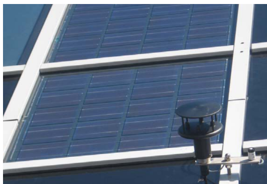
(a) Detail kristalline Photovoltaik und Messinstrumente für Strahlung und Windgeschwindigkeit
