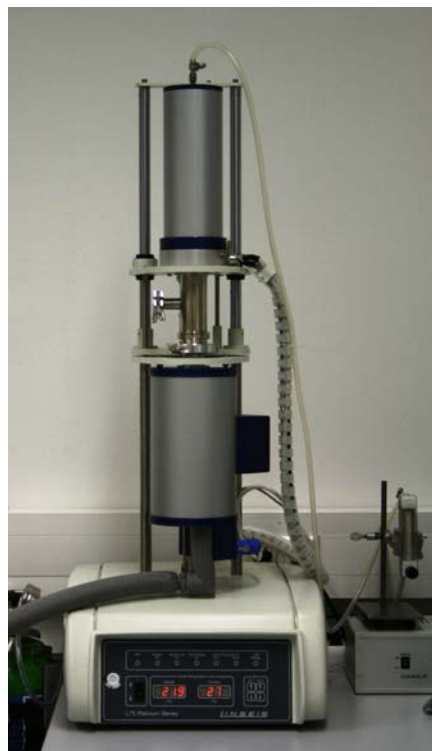
Abb. 16: Gesamtansicht des vertikalen Doppeldilatometers Linseis L 75 VD 500 LT (Foto: Bernd Oberdorfer)
