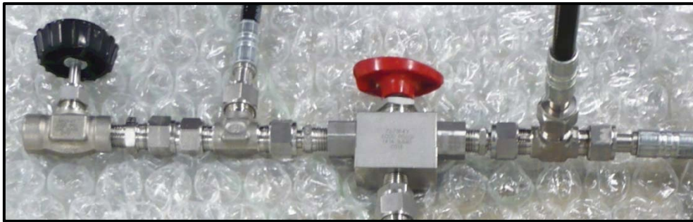
Abbildung 39: Anschlüsse des 3/3 Kugelventils
