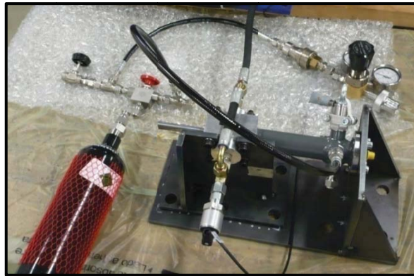
Abbildung 53: Befestigung von Bremse und Zylinder am Prüfstand
