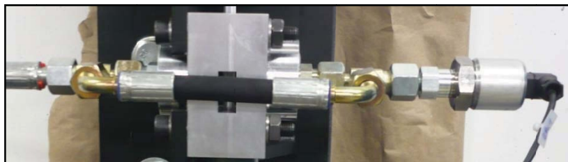
Abbildung 55: Bremsattel mit Hydraulikleitung und Drucksensor
