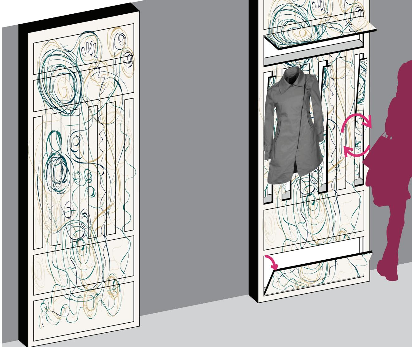
Die Garderobe besteht aus einem Schuhschrank, Kleiderhängern und einem Schränkchen für Kleinkram (Handschuhe, Schal usw. ). Durch leichten Druck auf den unteren Bereich des Schuhschranks und der Kleiderhalterungen, klappen diese oben durch einen Drehmechanismus aus.
