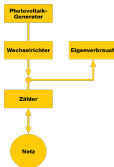
Abbildung 34: Schematische Darstellung einer Überschussanlage 53
