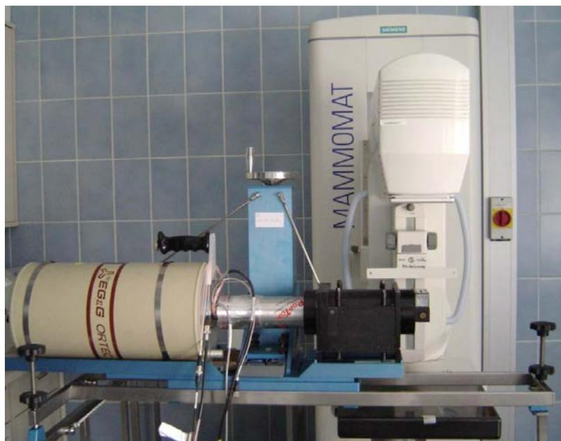
**Abbildung 42:** Spektrometer und HP Ge-Detektor auf der goniometrischen Vorrichtung
