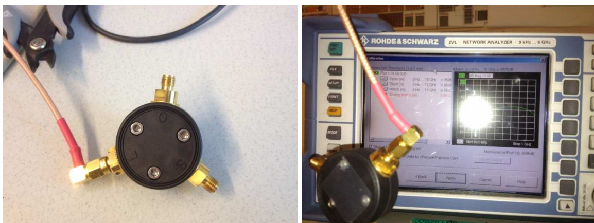
Abb. 5.2: Kalibrierstecker (calibration kit), Netzwerkanalysator und 50 Ohm Kabel
